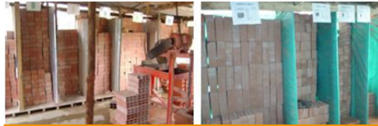
Fotografía de una zona de corte y almacenamiento por tipo de piezas de ladrillo y bloque
